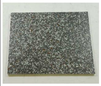
Plastifloor 418 RAL 6003, Chipsbelag teilgechipst, R9 mit Chipsmischung C5
